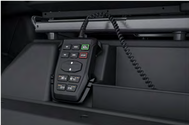
Unité de commande pour suspension pneumatique à régulation électronique (VASC)
