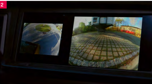
1 Système d'infodivertissement avec écran 12 pouces et MAN SmartSelect 2 À droite : image de la caméra de l'assistant de marche arrière (Reversing Motion System) lors de la mise sur sellette À gauche : image de la caméra avant avec MAN OptiView
